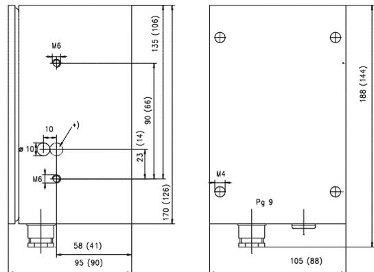
\*) Bohrung bei Größe 24 um 10 mm versetzt
