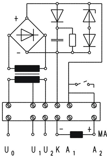
Bei gleichstromseitigem Schalten, Brücke entfernen!
