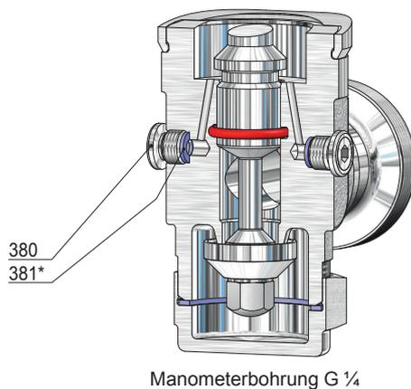
Manometerbohrung G 1/4
