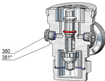
Manometerbohrung G 1/4
