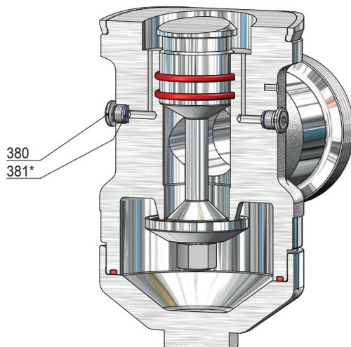
Manometerbohrung G 1/4
