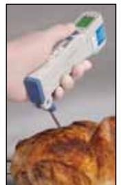
La sonda de penetración por contacto es basculante para permitir controles de temperatura rápidos.
