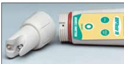
Los sensores del electrodo son fácilmente reemplazables sin afectar su clasificación a prueba de agua.
