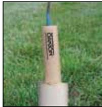
Las sondas sumergibles caben fácilmente en bocas de pozos de 5.1 cm (2").
