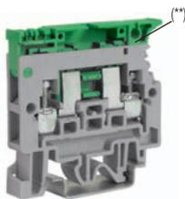
Il morsetto è provvisto di leva disezionamento con foro (\*\*) predisposto per eventuale sigillatura del coltello o per l'inserimento di un nottolino per la manovra simultanea di più coltellini contigui
