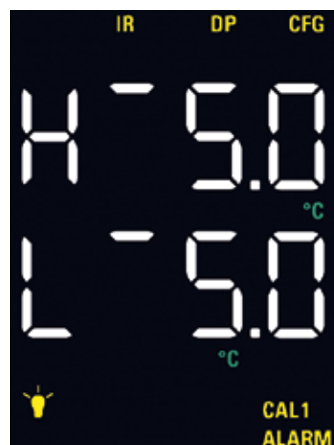
Einstellung des Taupunktalarms
